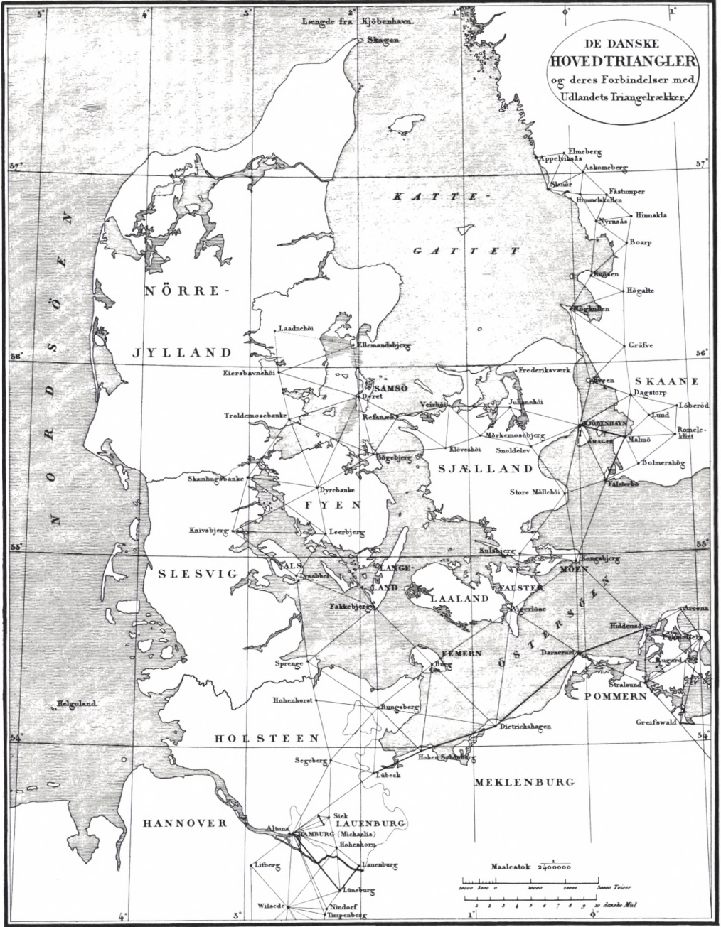
Reproduktion af Tab. I i C. C. G. Andræ: Den danske Gradmaaling, Bind 1 , der viser De danske Hovedtriangler og Deres Forbindelser med Udlandets Triangelrækker .
