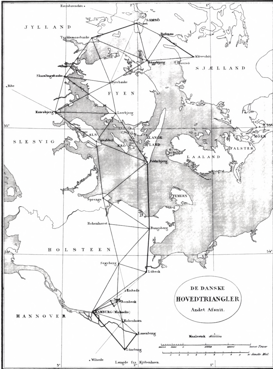
Reproduktion af Tab. 1 i C. C. G. Andræ: Den danske Gradmaaling, Bind 2 , der viser De danske Hovedtriangler, andet Afsnit af Andræ's udjævning af Schumachers målinger. De nordligste af de viste stationer blev først målt i den anden gradmålingsperiode.
